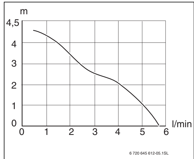
Fig. 3 Portata (l/min) in funzione della prevalenza (m)
