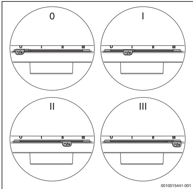
Bild 23 Verbrennungsluftschieber regulieren
