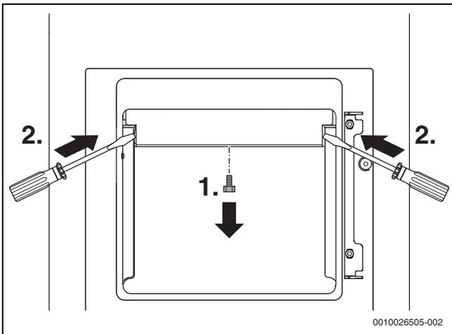
Bild 18 Sicherungsschraube entfernen und Isolierstein nach hinten drücken
