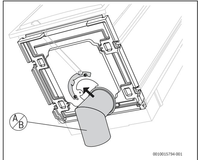
Bild 10 Verbrennungsluftstutzen installieren
