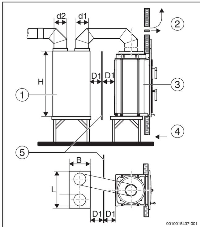
Bild 14 Heizeinsatz mit senkrechter Kuppel (schematische Darstellung)
