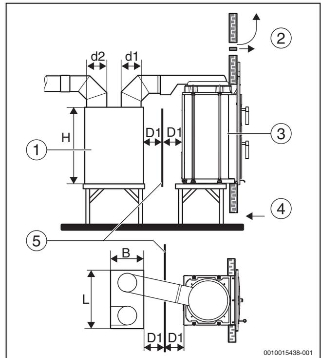
Bild 15 Heizeinsatz mit waagerechter Kuppel (schematische Darstellung)
