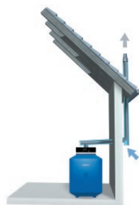
Raumluftunabhängige Aufstellvariante mit Rohr-in-Rohr-Kunststoff-Abgassystem entlang der Außenfassade.
