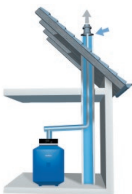
Raumluftunabhängige Aufstellvariante mit eingezogener Kunststoff-Abgasleitung im Schornstein.
