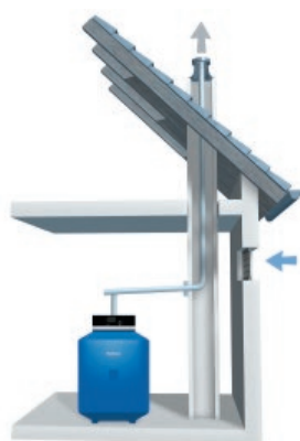
Raumluftabhängige Aufstellvariante mit eingezogenem Abgasrohr im Schornstein.
