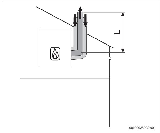
Bild 9 Vertikale konzentrische Luft-Abgas-Führung nach C<sub>33x</sub>
