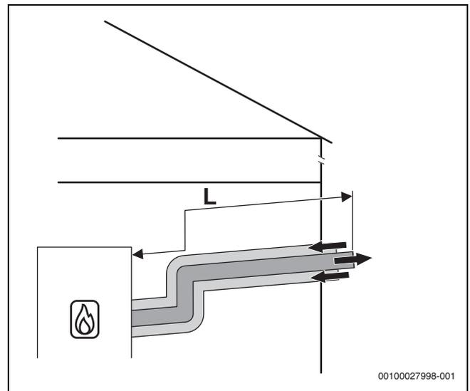
Bild 7 Horizontale konzentrische Luft-Abgas-Führung nach C<sub>13x</sub> durch die Außenwand
