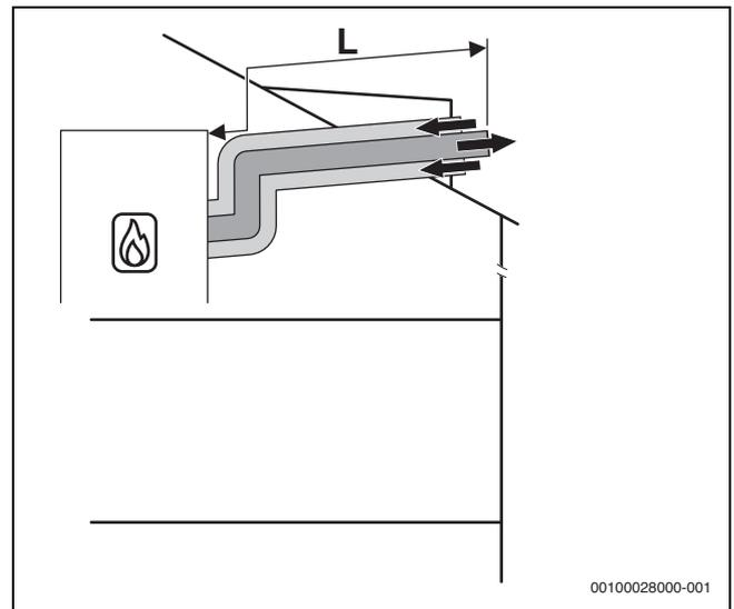
Bild 6 Horizontale konzentrische Luft-Abgas-Führung nach C<sub>13x</sub> über das Dach
