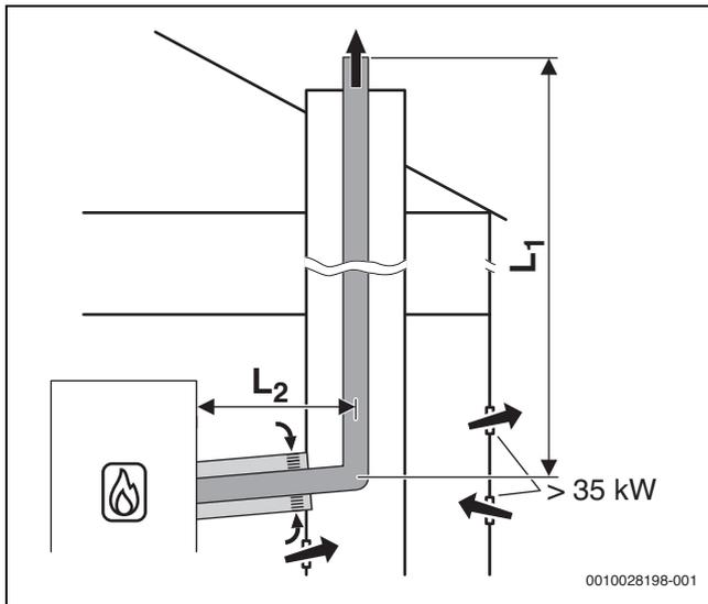
Bild 18 Starre Abgasführung im Schacht nach B<sub>33</sub> mit raumluftabhängiger Luftzufuhr über die konzentrische Luft-Abgas-Führung im Aufstellraum
