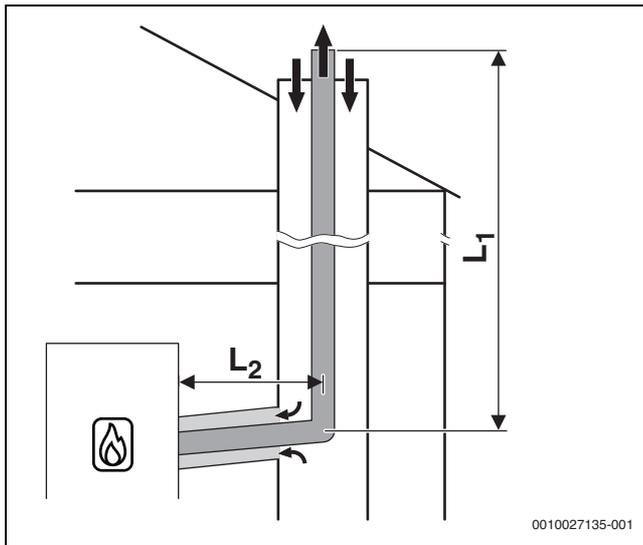
Bild 13 Starre Abgasführung nach C<sub>93x</sub> im Schacht und konzentrische Luft-Abgas-Führung im Aufstellraum10.2 Flexible Abgasführung nach C<sub>93x</sub> im Schacht
