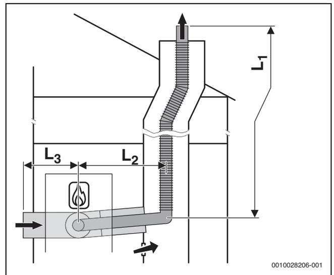
Bild 11 Flexible Abgasführung nach C<sub>53x</sub> im Schacht und Luft-Abgas-Führung mit separater Luftzufuhr und konzentrischer Abgasableitung im Aufstellraum
