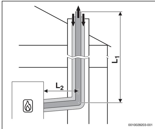
Bild 8 Konzentrische Luft-Abgas-Führung nach C<sub>33x</sub> im Schacht
