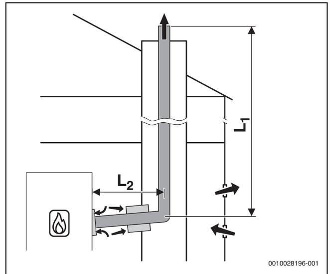
Bild 16 Starre Abgasführung im Schacht nach B<sub>23p</sub>/B<sub>53p</sub> mit raumluftabhängiger Luftzufuhr am Wärmeerzeuger und konzentrischem Verbindungsstück zwischen Aufstellraum und Schacht
