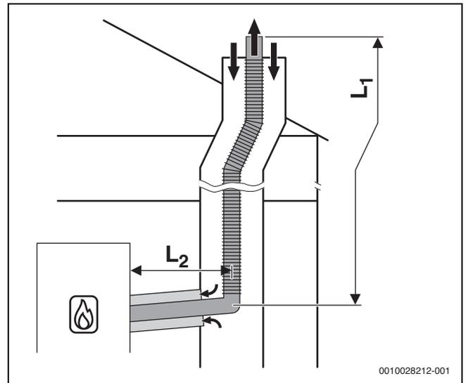
Bild 14 Flexible Abgasführung nach C<sub>93x</sub> im Schacht und konzentrische Luft-Abgas-Führung im Aufstellraum
