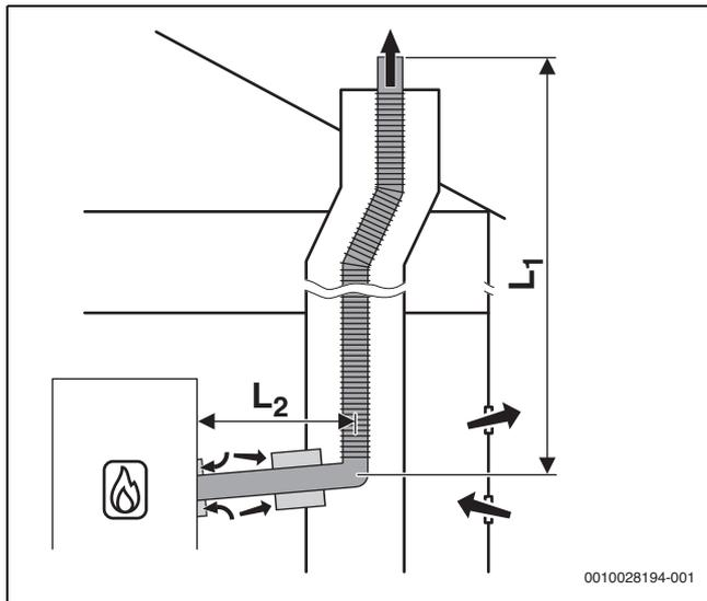
Bild 17 Flexible Abgasführung im Schacht nach B<sub>23p</sub>/B<sub>53p</sub> mit raumluftabhängiger Luftzufuhr am Wärmeerzeuger und konzentrischem Verbindungsstück zwischen Aufstellraum und Schacht
