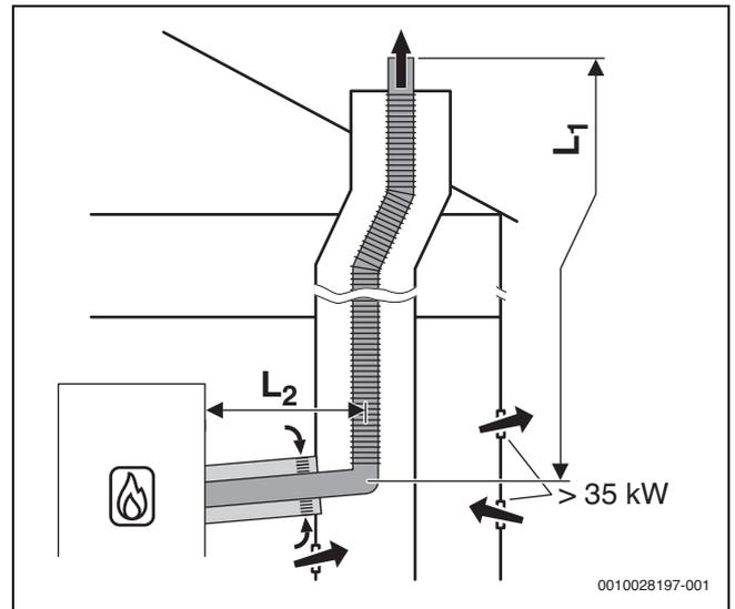
Bild 19 Flexible Abgasführung im Schacht nach B<sub>33</sub> mit raumluftabhängiger Luftzufuhr über die konzentrische Luft-Abgas-Führung im Aufstellraum
