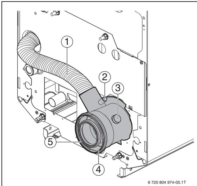
Bild 15 Luft-Abgas-Anschlussstutzen montieren
