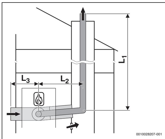
Bild 10 Starre Abgasführung nach C<sub>53x</sub> im Schacht und Luft-Abgas-Führung mit separater Luftzufuhr und konzentrischer Abgasableitung im Aufstellraum
