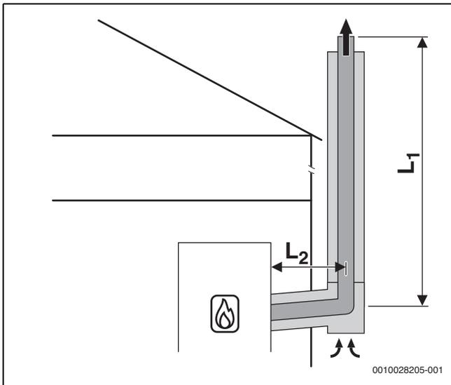
Bild 12 Konzentrische Luft-Abgas-Führung nach C<sub>53x</sub> an der Außenwand
