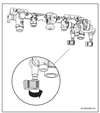
Bild 6 Fülleinrichtung öffnen
