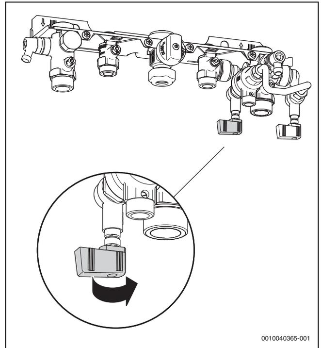
Bild 6 Füllrichtung öffnen
