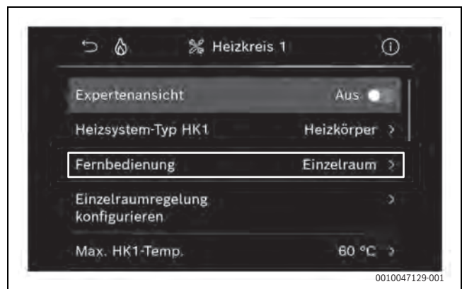
Bild 3 Beispiel Gas-Brennwertgerät; Einzelraumregelung Heizkörper
