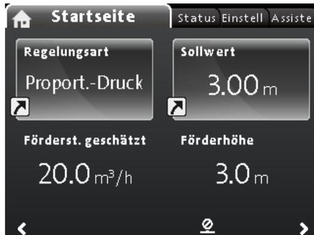
Abb. 34 Beispielhafte Darstellung des Menüs "Home" mit einer Übersicht über die Einstellungen und die Förderleistung
