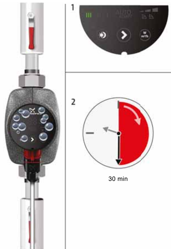
Abb. 8 Entlüften der Pumpe
