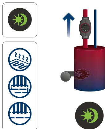
Abb. 21 Voraussetzungen für die automatische Nachtabsenkung
