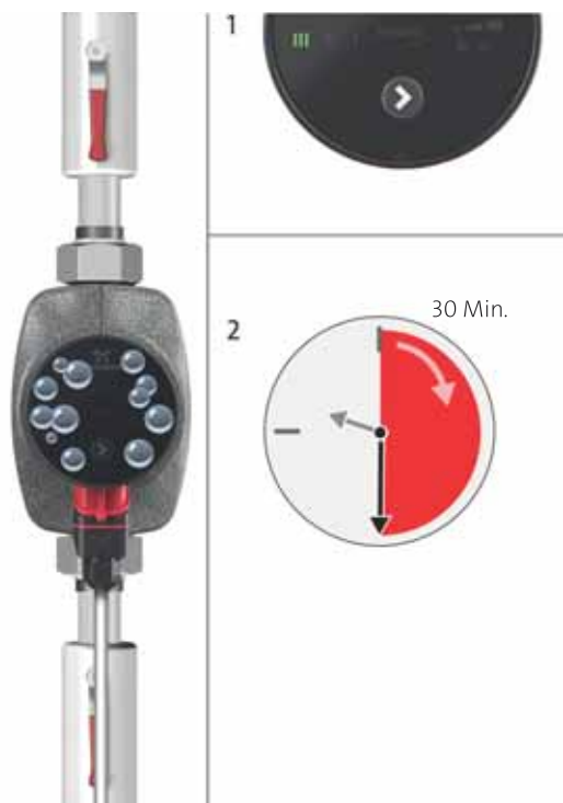
Abb. 8 Entlüften der Pumpe
