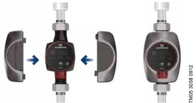
Abb. 5 Isolieren des Pumpengehäuses
