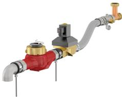
Ablassmodul für Flamcomat mit SPC-Steuerung. Schützt vor dem Überfüllen des Hauptgefäßes, wenn das Ausdehnungsvolumen vorübergehend größer ist als das Volumen des Gefäßes. Erhältlich mit Wasserzähler oder Impulswasserzähler für einen Durchfluss (Kvs) von 16 bzw. 20 m<sup>3</sup>/h. Die Varianten mit einem Impulswasserzähler ermöglichen die Überwachung der Durchflussrate durch die SPC-Steuereinheit.
