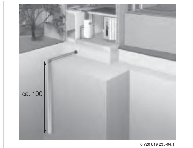
Bild 5 Erdwärmesonden (Maße in m)
