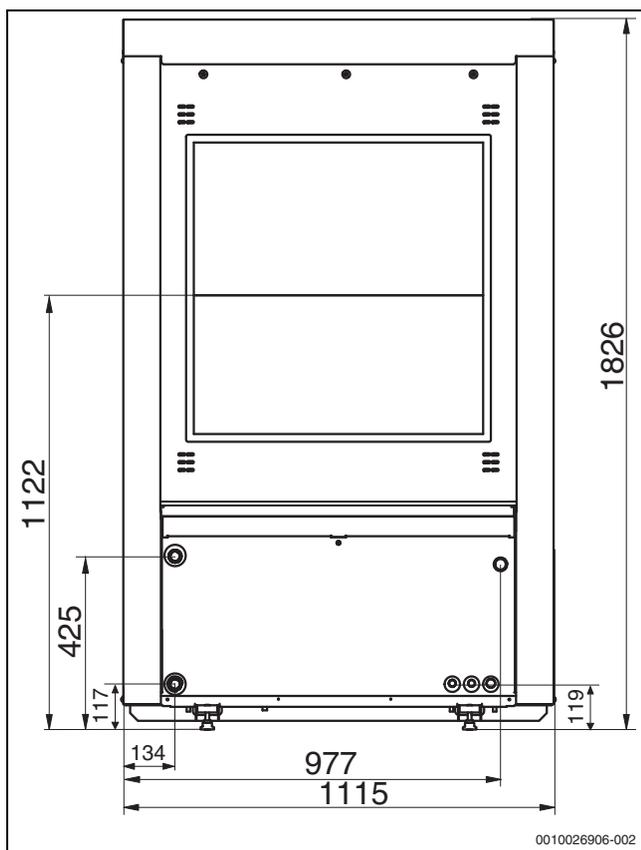
Bild 6 Abmessungen und Anschlüsse der Wärmepumpenmodelle 11.2–14.2, Rückseite
