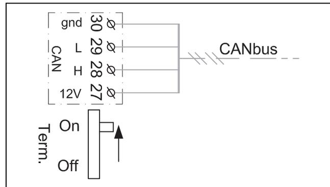
Bild 32 CAN-BUS-Terminierung
