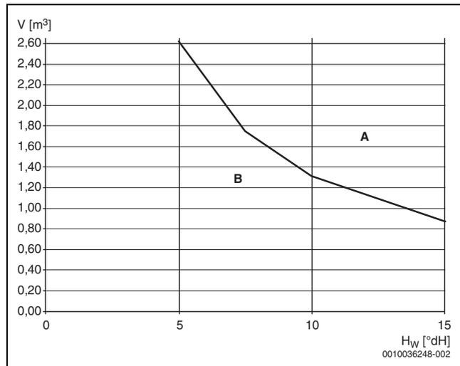
Bild 1 Grenzwerte für die Wasseraufbereitung bei Wärmepumpenanlagen
