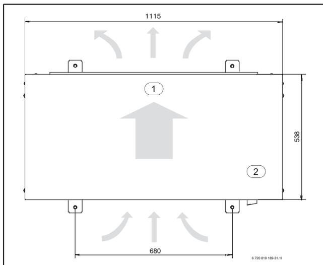
Bild 7 Abmessungen der Wärmepumpenmodelle 11.2–14.2, Ansicht von oben
