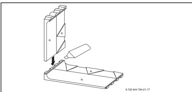
Bild 15 Steckelemente zusammenstecken
