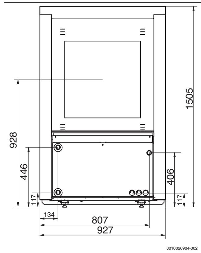
Bild 4 Abmessungen und Anschlüsse der Wärmepumpenmodelle 6.2–8.2, Rückseite
