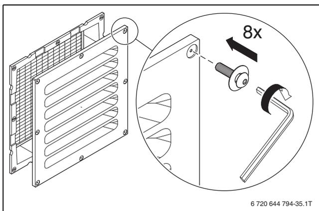
Bild 28 Wetterschutz-/Regenschutzgitter befestigen
