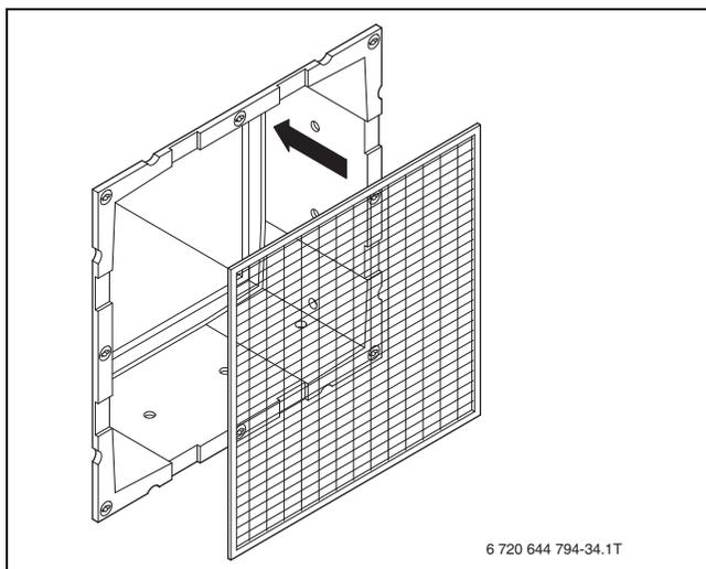
Bild 27 Maschendrahtgitter befestigen
