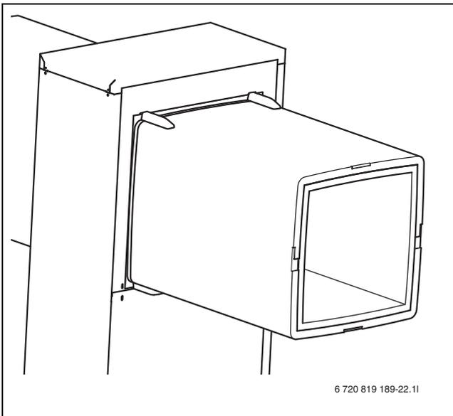
Bild 24 Schutzkappen befestigen
