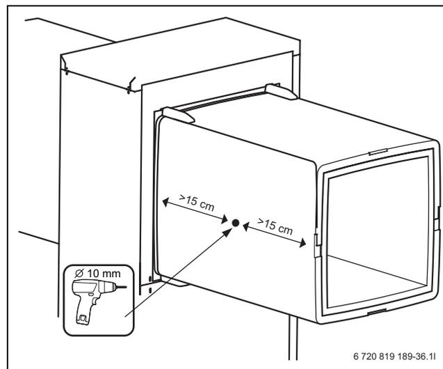
Bild 29 Fühler montieren
