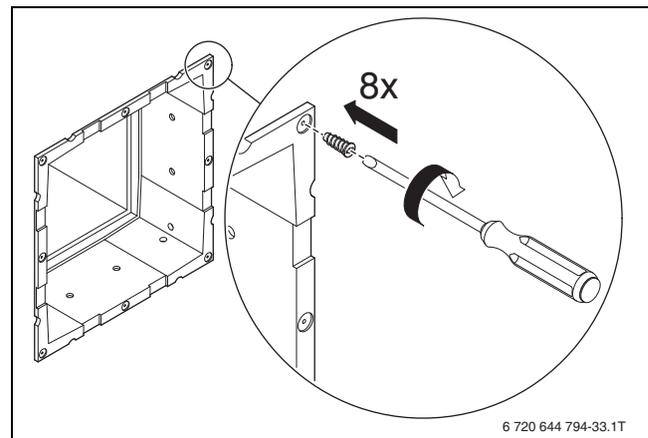
Bild 26 Einbaurahmen befestigen
