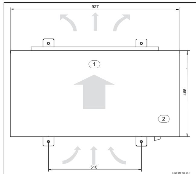
Bild 5 Abmessungen der Wärmepumpenmodelle 6.2–8.2, Ansicht von oben
