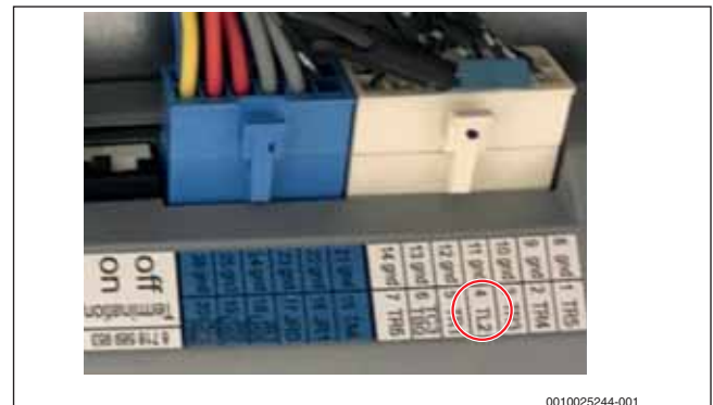
Bild 10 Referenzfühler TL2 an der I/O-Modul-Platine
