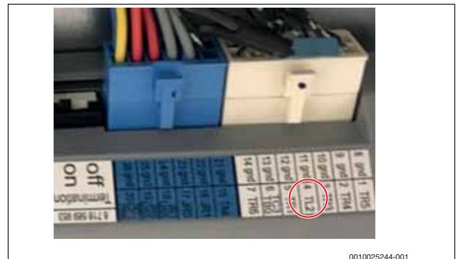
Bild 13 Referenzfühler TL2 an der I/O-Modul-Platine
