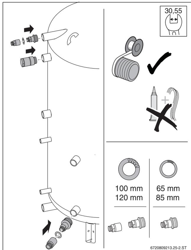
Bild 12 Anschlussstücke einschrauben
