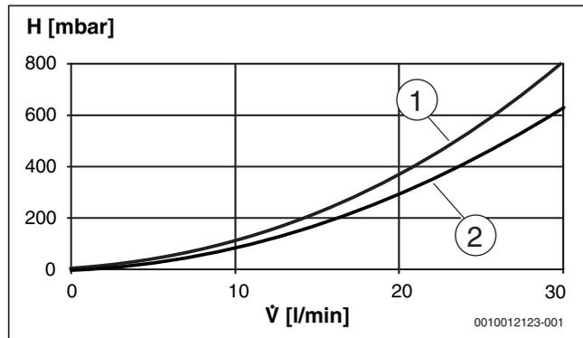
Bild 7 Druckverlust Sekundärseite
