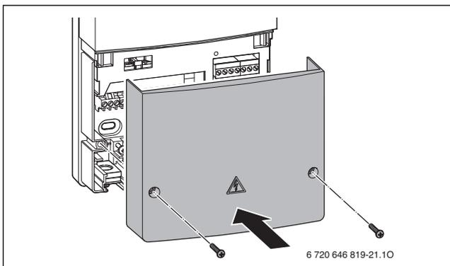
Bild 37 Abdeckung montieren
