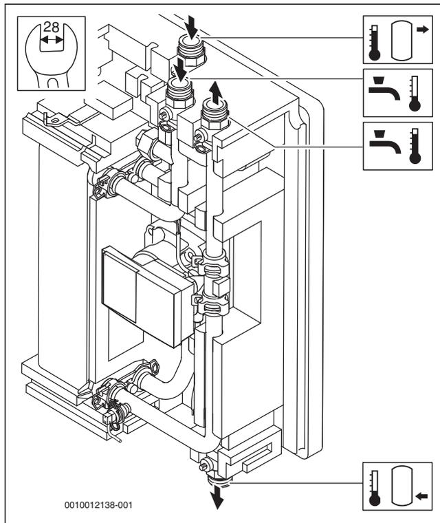
Bild 25 Anschlüsse Frischwasserstation
