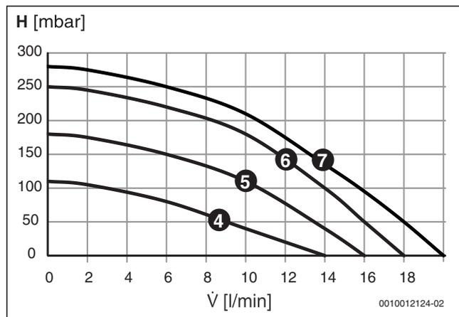
Bild 8 Kennlinie Zirkulationspumpe im Zirkulationsstrang (Zubehör, Pumpenstufen 4 - 7)
