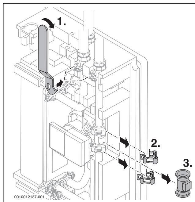
Bild 44 Volumenstromfühler demontieren
