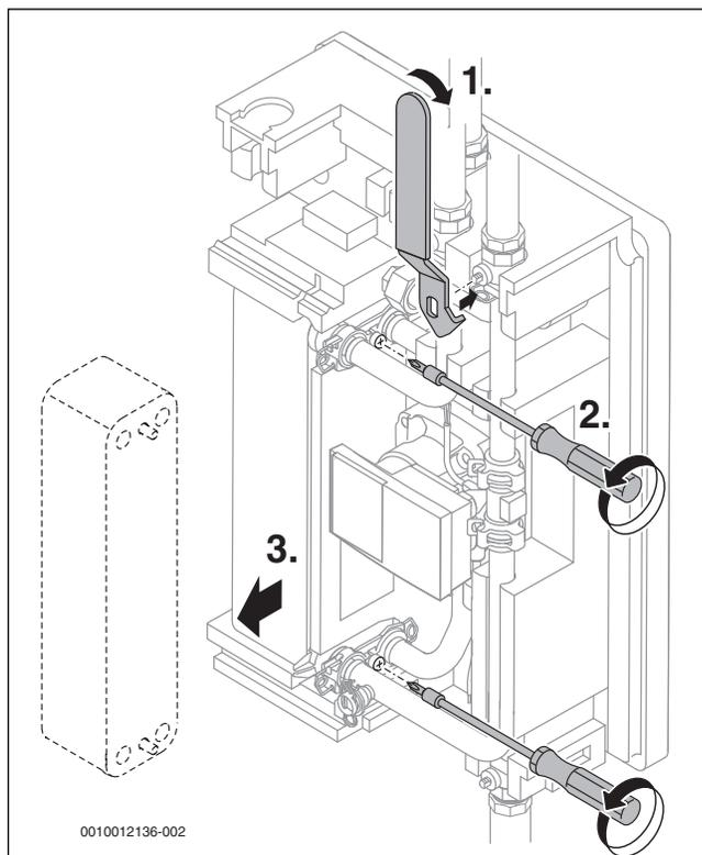
Bild 43 Wärmetauscher demontieren
