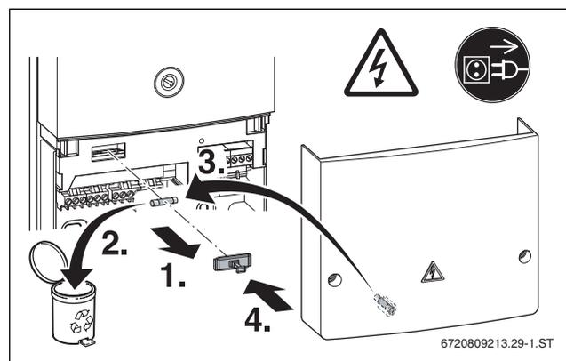
Bild 45 Sicherung tauschen
