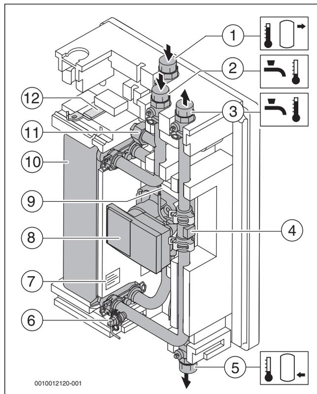
Bild 3 Frischwasserstation ohne vorderen Wärmeschutz, ohne Modul
