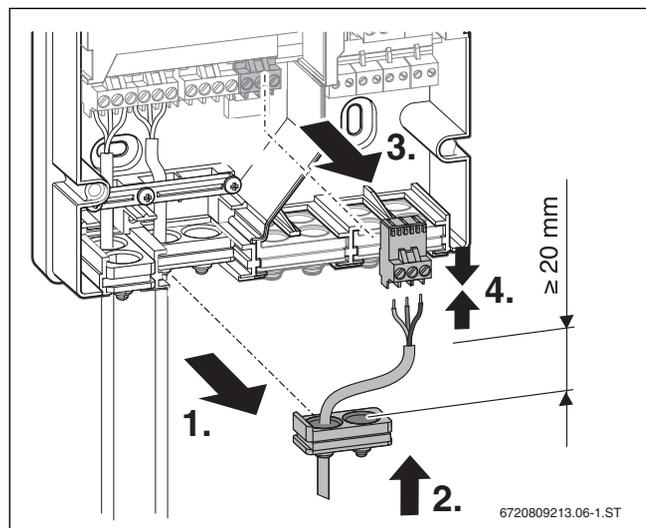
Bild 35 Pumpe anschließen (Zirkulation oder tägliche Aufheizung)
