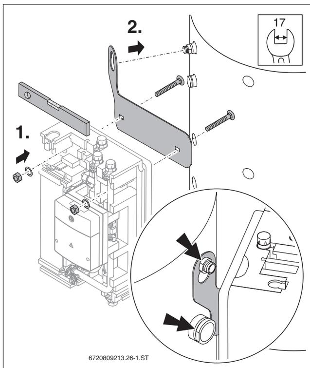
Bild 14 Halblech montieren
