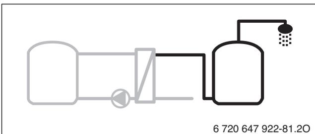
Bild 30 Display: Vorwärmen des Warmwassers mit der Frischwasserstation
