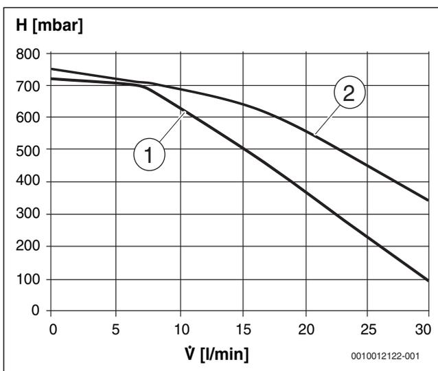
Bild 6 Restförderhöhe Primärkreispumpe
