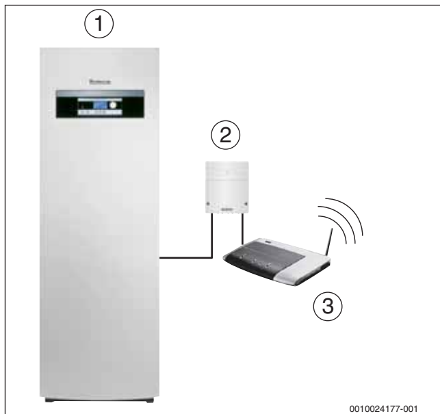
Bild 14 Sole-Wasser-Wärmepumpe in Kombination mit web KM200
