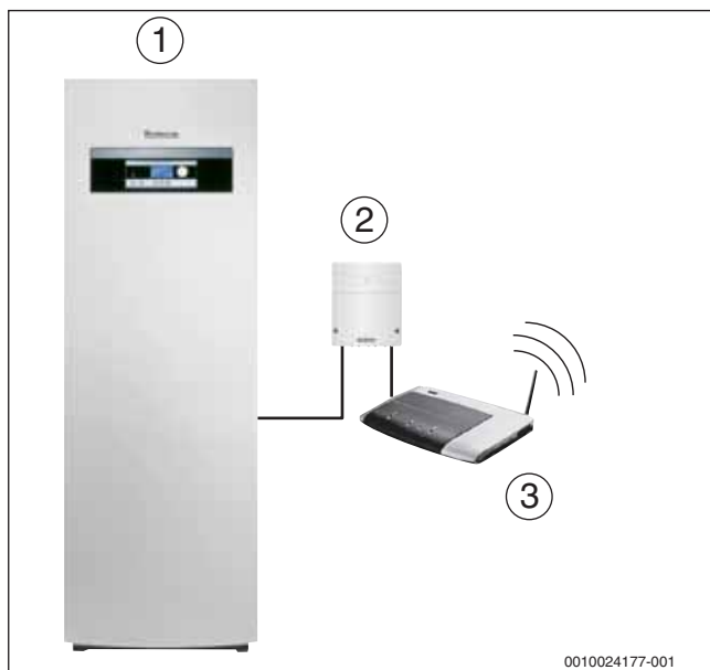
Bild 21 Sole-Wasser-Wärmepumpe in Kombination mit web KM200
