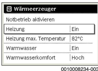
Um die maximale Vorlauftemperatur für die Heizung einzustellen:
