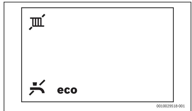
Bild 3 Heizung und Warmwasserbereitung ausgeschaltet
