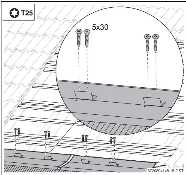
Bild 34 Abrutschsicherungen befestigen
