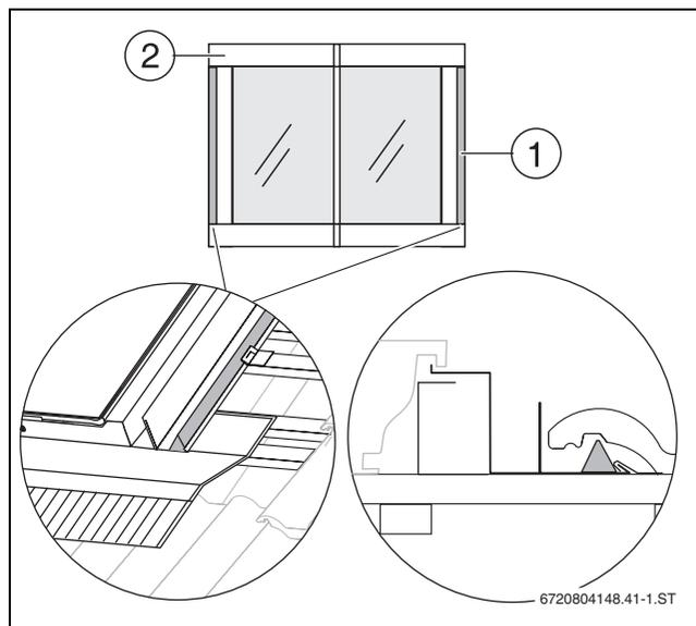
Bild 74 Dreiecksdichtband einlegen
