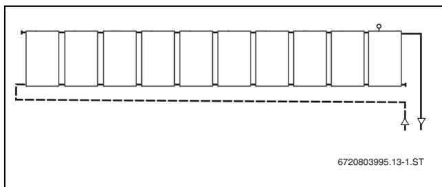
Bild 17 Wechselseitiger Anschluss (1 Reihe)
