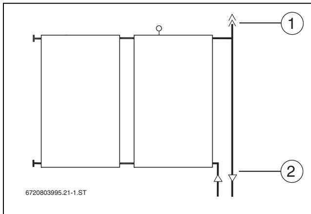
Bild 56 Hydraulik mit Entlüfter
