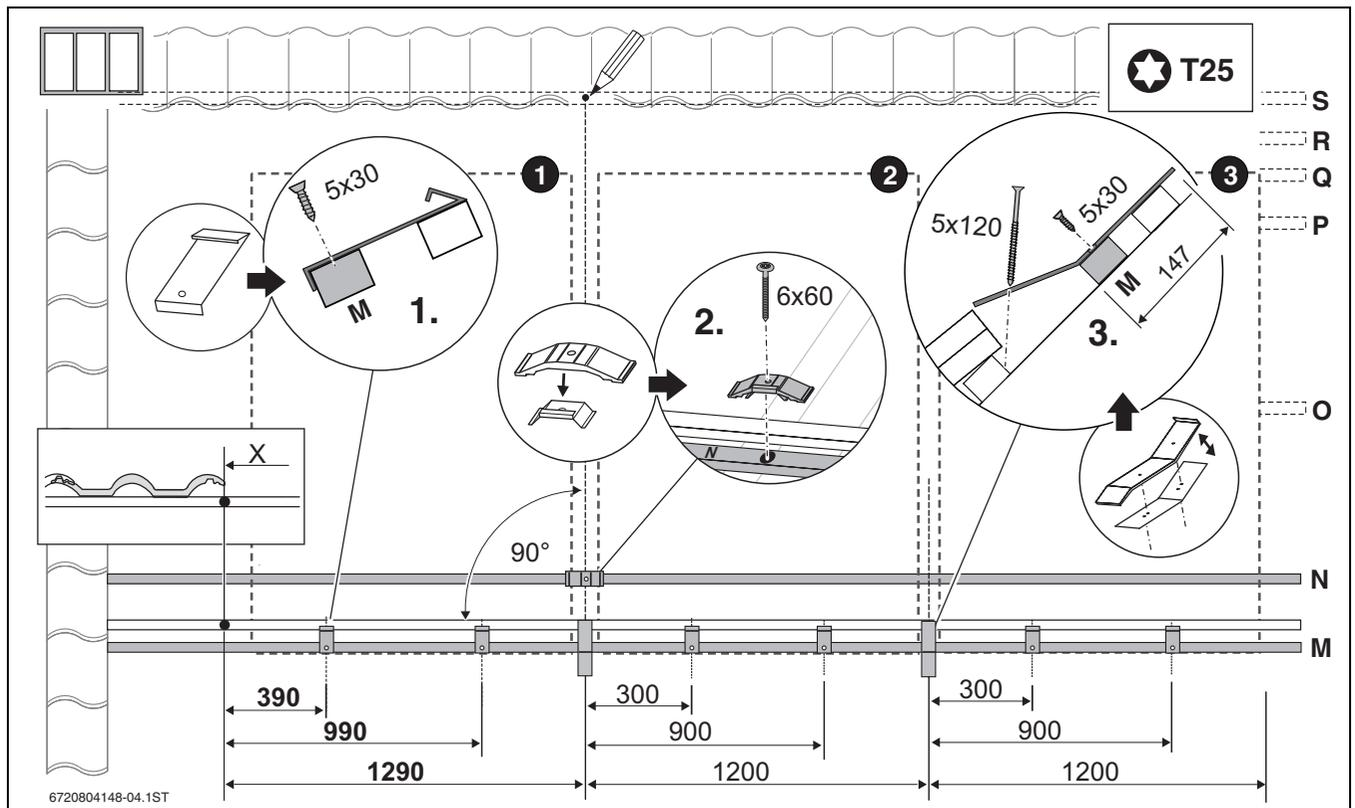
Bild 29 Kollektortyp senkrecht (3 Kollektoren), Maße in mm
