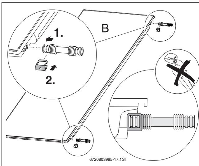
Bild 38 Verbindungs-Set am zweiten und allen weiteren Kollektoren
