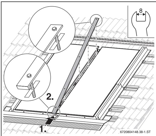
Bild 66 Abdeckleiste montieren
