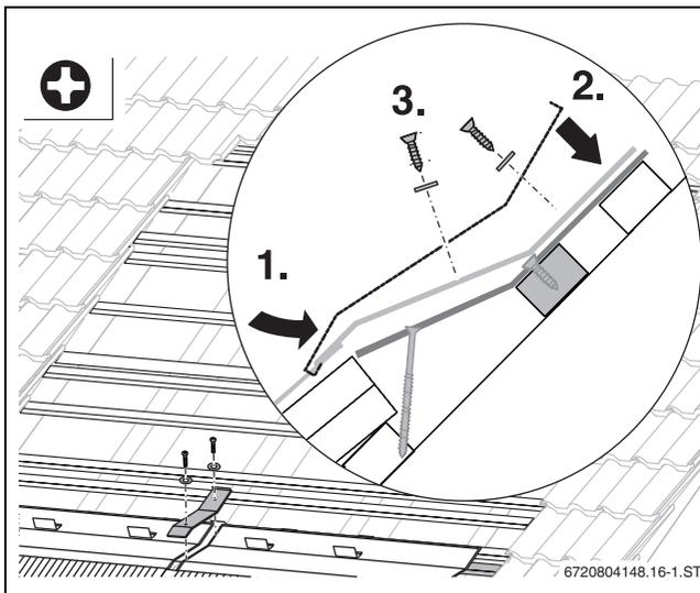
Bild 35 Oberteil montieren
