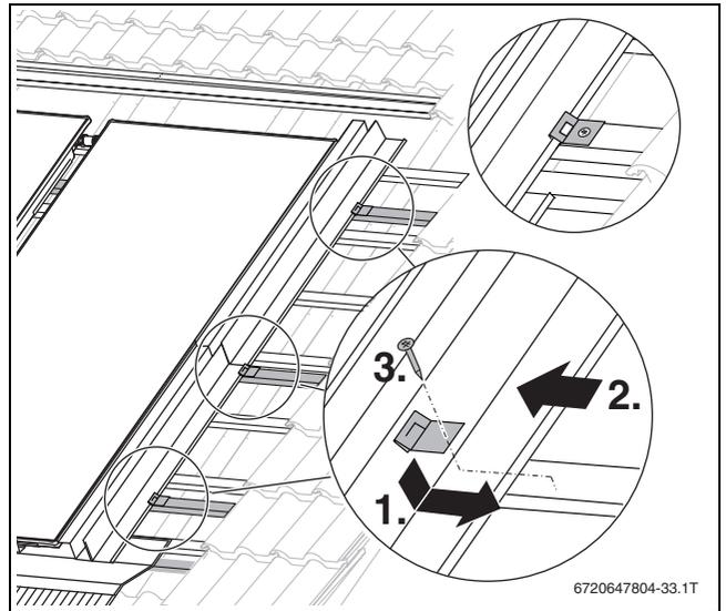
Bild 63 Haftern montieren
