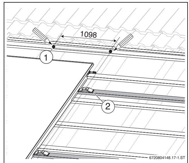
Bild 44 Montageposition des oberen Verbinders bei waagerechten Kollektoren
