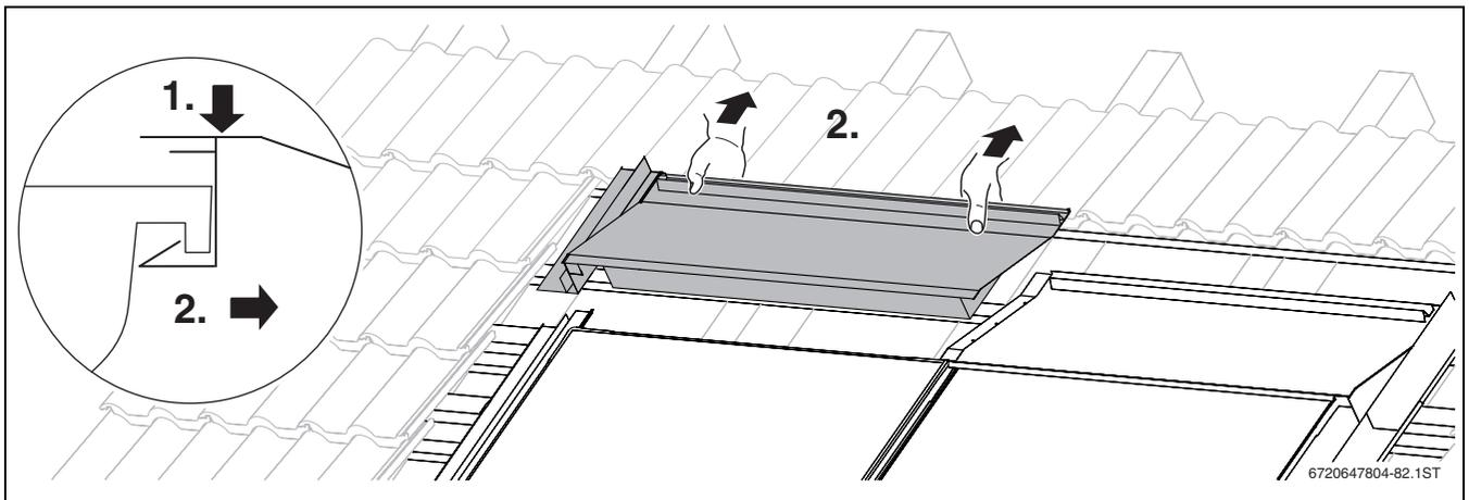
Bild 82 Eindeckblech abziehen
