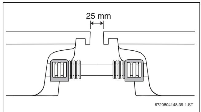
Bild 48 Gesicherter Wellrohrverbinder
