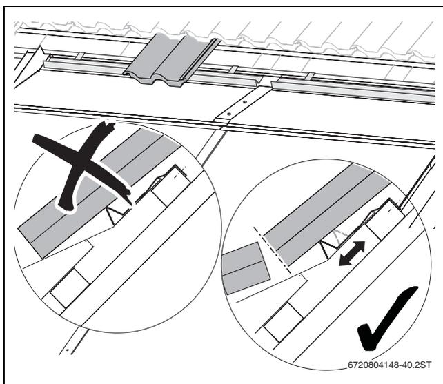
Bild 79 Dachziegelauflage positionieren
