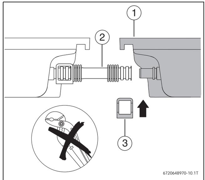
Bild 47 Wellrohrverbinder sichern
