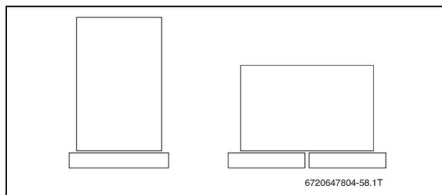
Bild 28 Anordnung bei Single-Kollektor (links: senkrecht; rechts: waagrecht)
