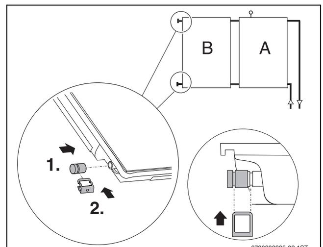
Bild 36 Kappen montieren
