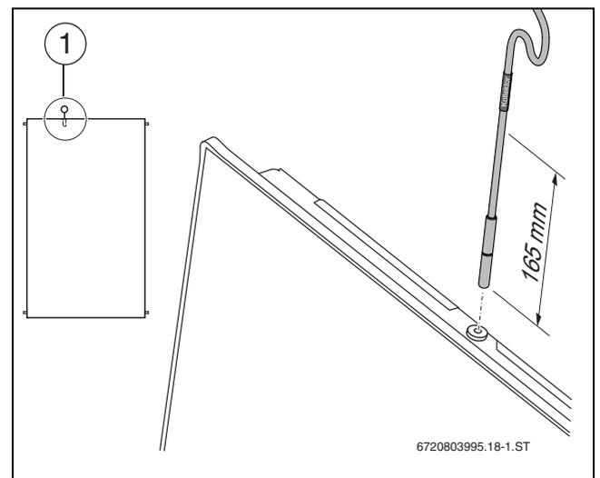
Bild 53 Kollektorfühler montieren
