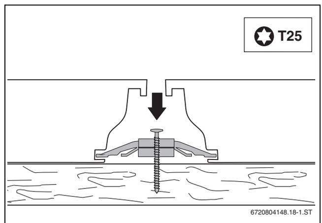
Bild 49 Schrauben festziehen
