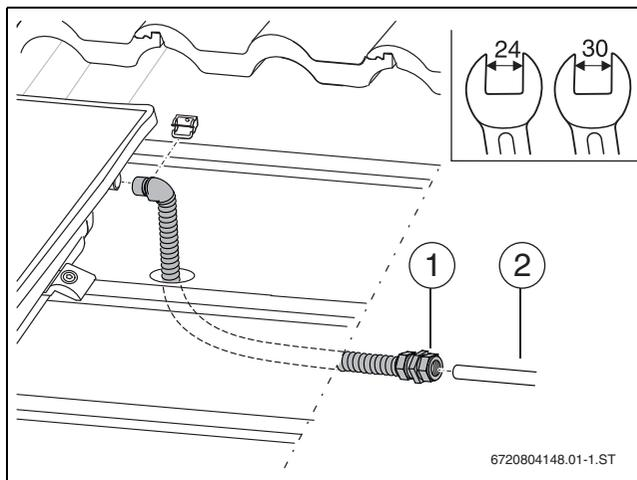
Bild 55 Rohrleitung (Vorlauf) durch das Dach führen
