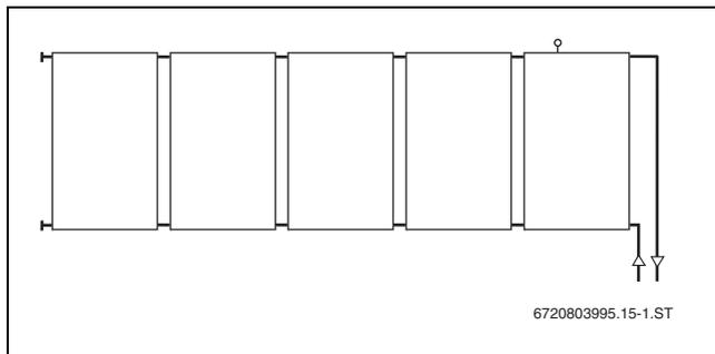
Bild 16 Gleichseitiger Anschluss rechts oder links (1 Reihe)
