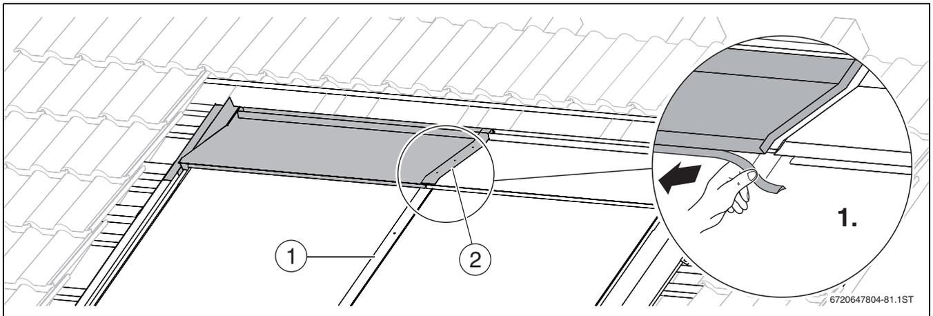
Bild 81 Dichtlippe abziehen
