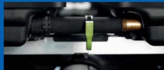
**Auf einen Klick:** Die Kollektoren lassen sich dank raffinierter Steckverbindung ohne Werkzeug montieren. Federbandschellen und TÜV-geprüfter Solarschlauch sorgen zudem für Robustheit und Langlebigkeit.
