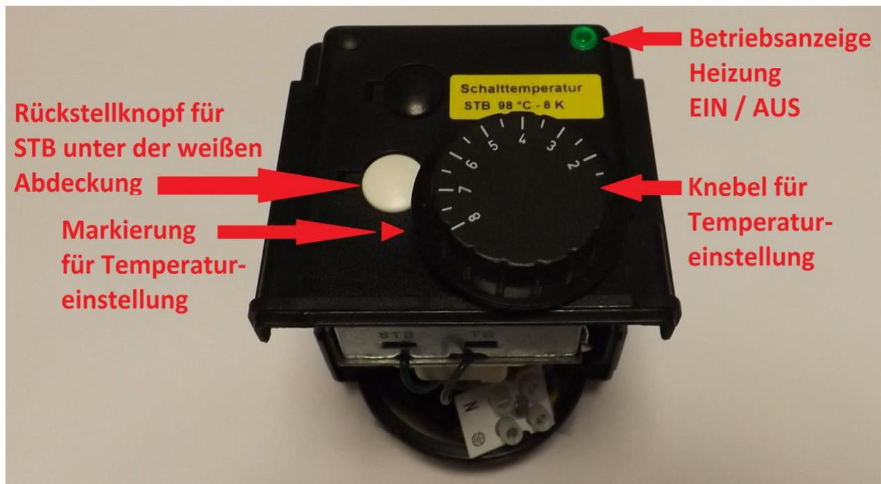
5. Bei der durch Wassermangel entstehende „**Trockenheizung**“ und den daraus resultierenden Übertemperaturen werden die Kapillare der Thermostaten geschädigt. Als Wassermangelsicherungen müssen andere Schutzfunktionen ausgewählt werden.
