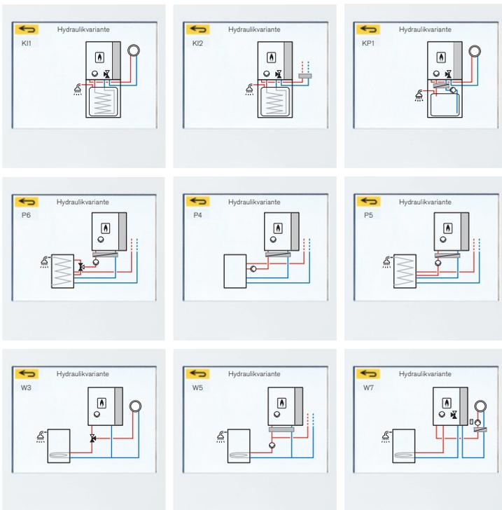
*Die Auswahl der passenden Hydraulik im Inbetriebnahme-Assistenten erfolgt über schematische Farbdarstellungen: einfach und schnell.*
