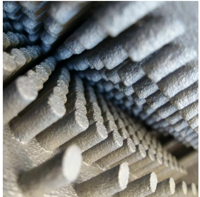
Detail des Wärmetauschers mit optimierten Oberflächen-Konturen
